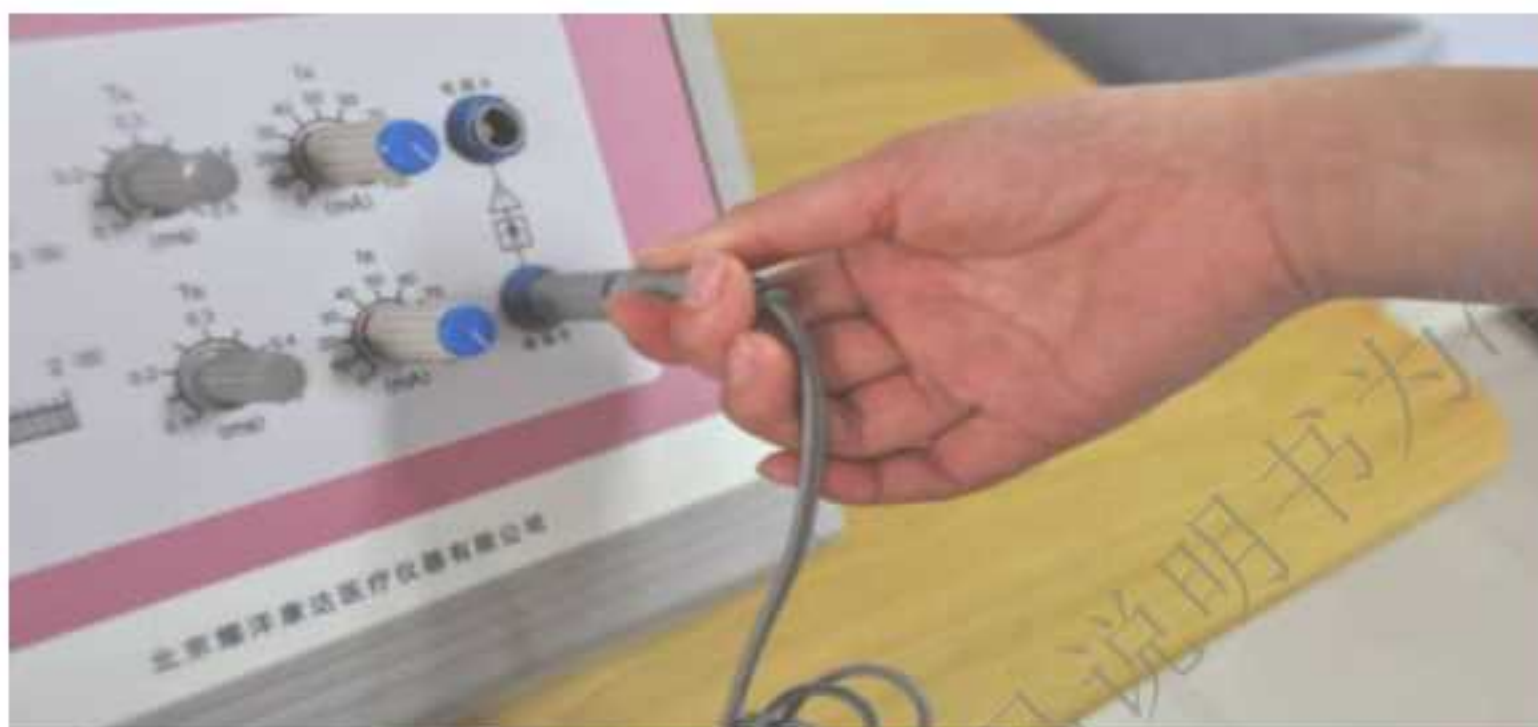
图 3f 错误的拔下方式
